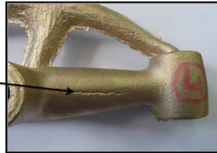
Fig.3 : Exemple de défauts : Présence d'une crique
